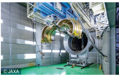
地上エンジン運転試験設備
