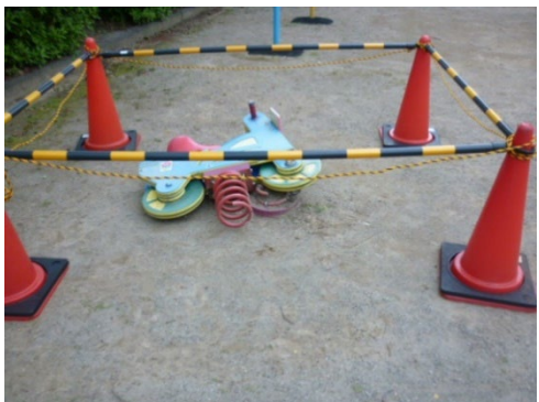
遊具利用中にスプリングが破断し、打撲及び捻挫
