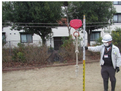
滑車部に指を挟む損傷：滑車からロープ下端までの長さが940mm (遊具の安全に関する規準：1,750mm)
