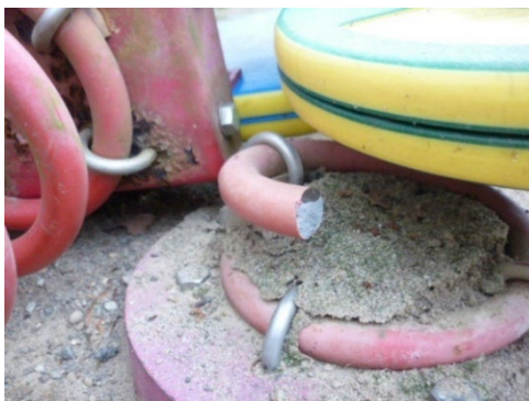
遊具利用中にスプリングが破断し、打撲及び捻挫
