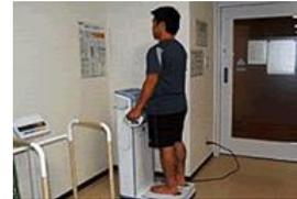
8電極測定方式体組成計
