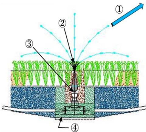
①100 ミクロンの微雨を半径 3~4m 散水させる。
