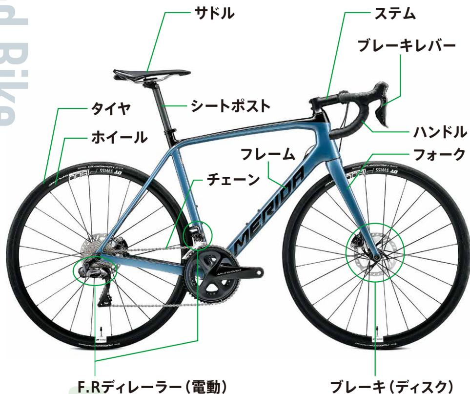
ドロップハンドル、細いタイヤ、車体が7kg前後と軽量で、長距離の舗装道路（オンロード）を高速で走行するのに向いているスポーツ自転車。30km/h以上出すことができ、スピード感と風を切って走る爽快感が特徴です。
