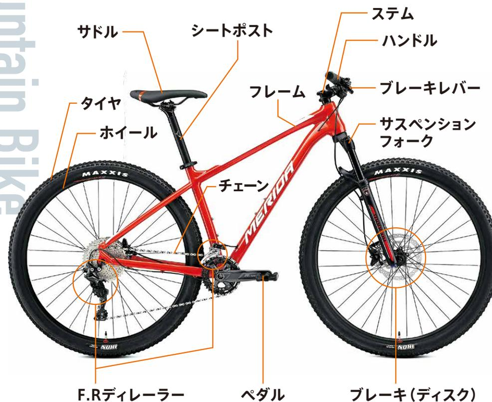
ゴツゴツした太いタイヤと頑丈なフレーム、衝撃を吸収するためのサスペンションを備え、荒野や山岳地帯などの未舗装路（オフロード）、急坂投降、段差越えなどのルートを走行するための自転車です。
