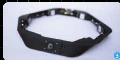
図①：無人飛行機（ドローン）との遠隔接続。図②：体外離脱視点によるスポーツトレーニング（上：ランナーに付随して飛翔するドローン、下：スイマーを伴泳する水中ロボット） 図③：複数の人間の能力をつなぎ合わせるJackIn（左は全周囲映像を取得するウェアラブルヘッドギア）
