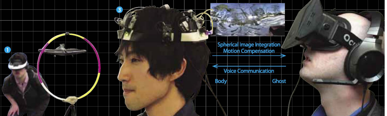
図①：無人飛行機（ドローン）との遠隔接続。図②：体外離脱視点によるスポーツトレーニング（上：ランナーに付随して飛翔するドローン、下：スイマーを伴泳する水中ロボット） 図③：複数の人間の能力をつなぎ合わせるJackIn（左は全周囲映像を取得するウェアラブルヘッドギア）
