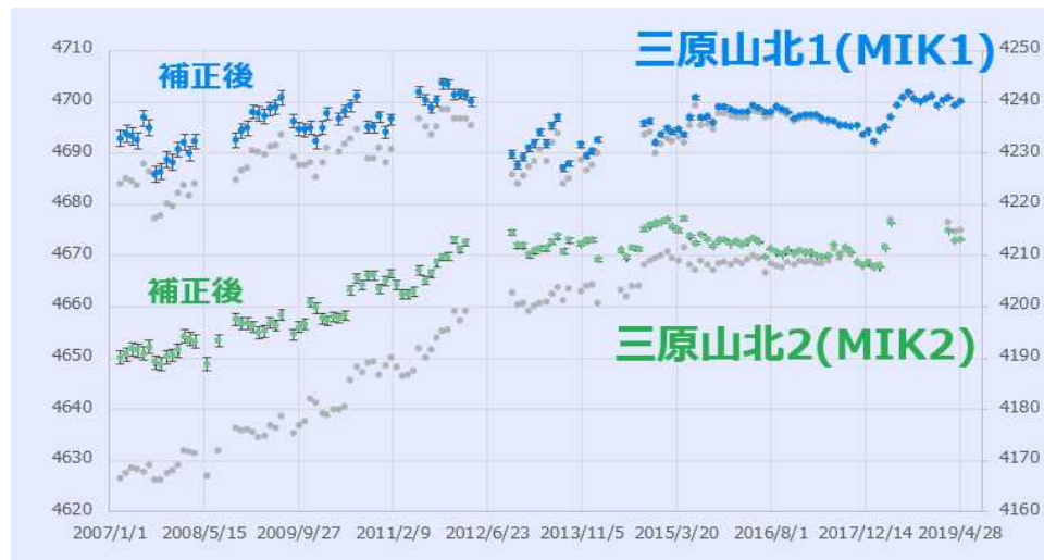
図2 三原山北1、三原山北2観測点におけるDI補正前後の全磁力変化（縦軸の単位はnT）
