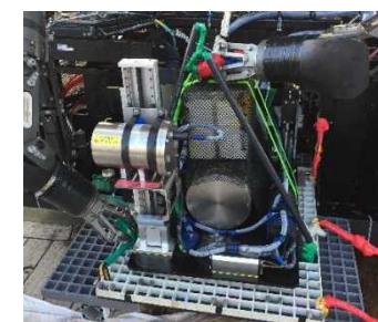
開発した移動式圧力校正器（MPC）。ROVで海底に運ぶ
