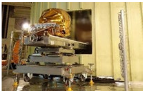
↑タンクモジュールを搭載する様子
