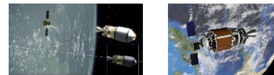
フェーズⅠ 非協力的ターゲットへのランデブ、左傍制御、映像の取得 フェーズⅡ 左記に加え、捕獲・除去 商業デブリ除去実証(CRD2)のイメージ
