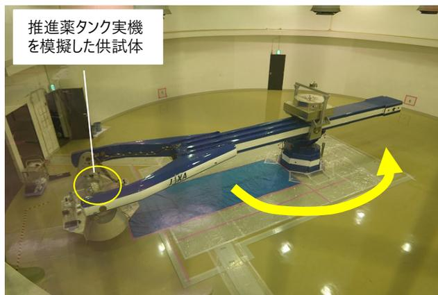
推進薬タンク実機を模擬した供試体
