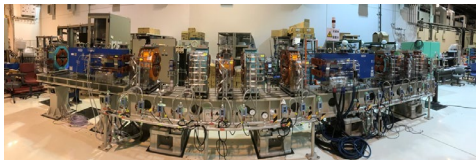
蓄積リング磁石セル (ハーフセル)
