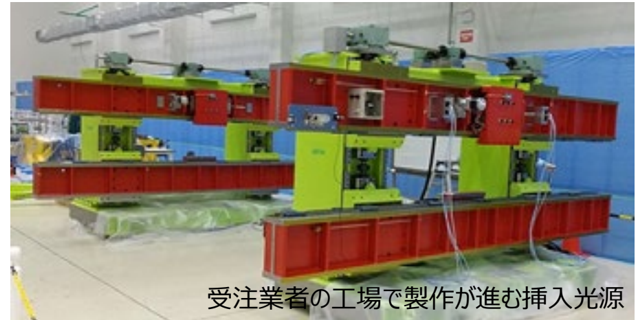
挿入光源の磁石 列間に設置される ビームダクト
