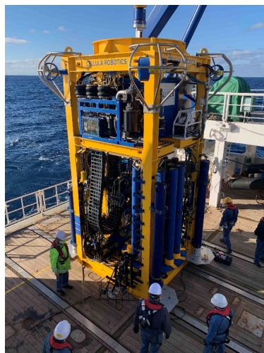
浅い孔内傾斜計の掘削を行う 海底着座型ボーリングマシン (BMS)
