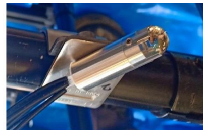
光ファイバにレンズを取り付けた受光部先端
