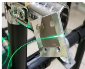
分岐されたファイバから放出されるレーザー光
