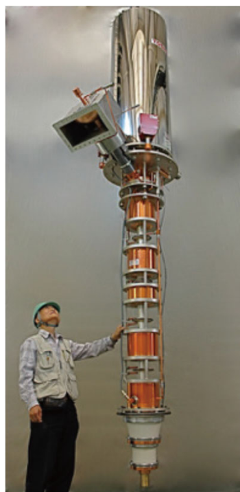
未来技術遺産に登録されたクライストロン（東芝電子管デバイス製）
