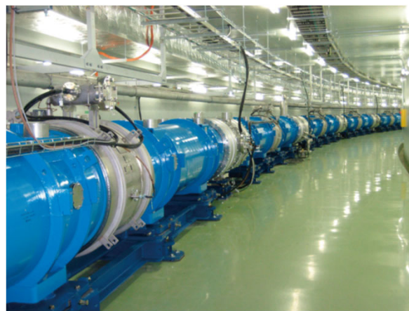
J-PARCのニュートリノ実験用ビームラインの超伝導磁石
