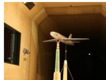
調布の風洞試験設備
