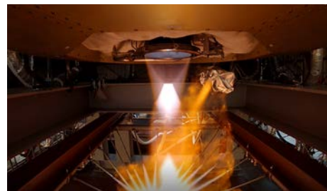
40%推力レベルの燃焼状況
