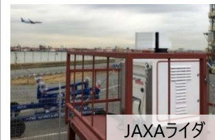
JAXAライダ 羽田空港でのライダによる後方乱気流の観測 （13ヶ月間で13,265機を観測）
