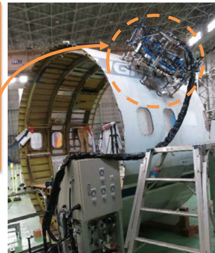
複合材自動修理ロボットの 機体取付試験
