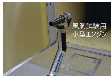
図1 小型エンジンを用いた低騒音風洞試験
