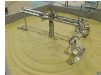
走行機構の長距離走行試験
