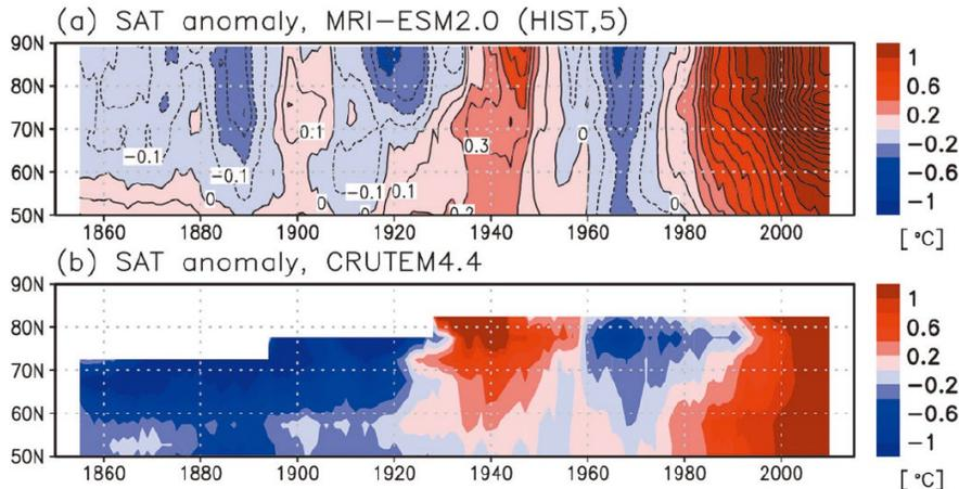
北緯50～90度での地上気温の変化。気候モデルMRI-ESM2.0による再現(a)と観測値(b)との比較。10年移動平均の帯状平均を示す。1941～1970年を基準とする。
