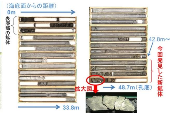
Hakureiサイトで船上設置型掘削装置で採取されたコアサンプル一例
