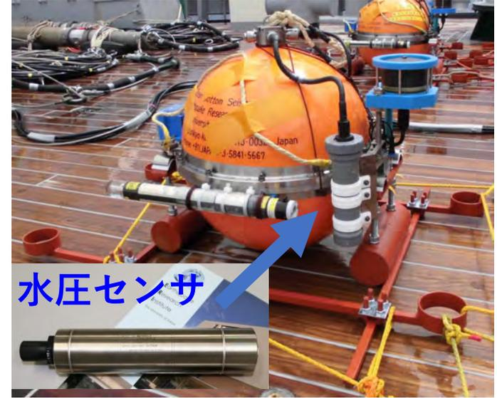
チタン合金製球型耐圧容器に観測装置を收容し、1年間以上海底において連続観測が可能、2000年代初め頃から実用化
