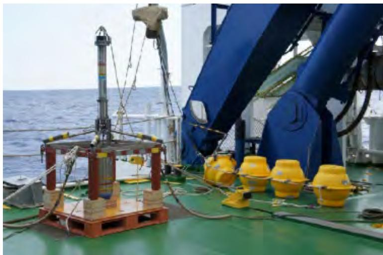
従来の海底地震計構造と異なる超深海型海底地震計の試作機。交代圧かが難しい水中ケーブルを使用しない構造。センサー埋設による高性能化も行う
