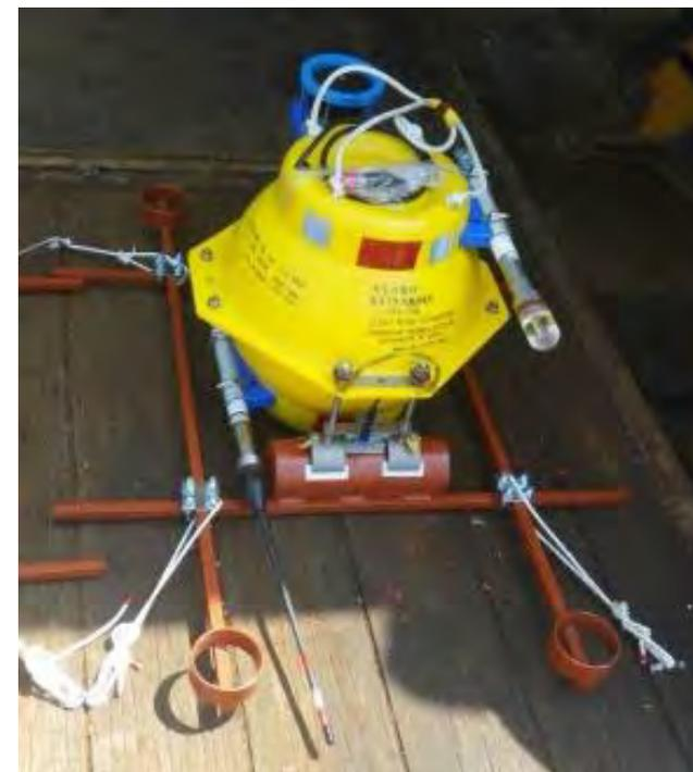
従来の海底地震計構造を踏襲した超深海型海底地震計の試作機。
