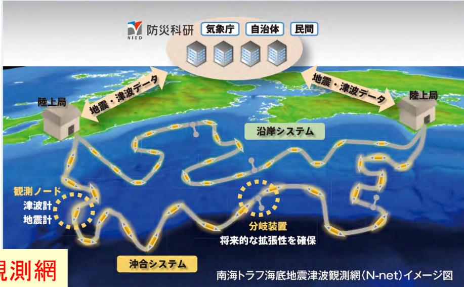
南海トラフ海底地震津波観測網(N-net)イメージ図
