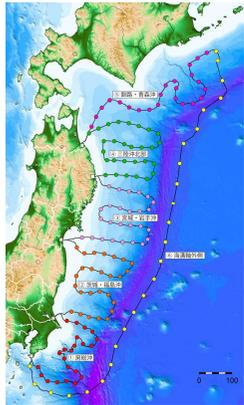
地震計と水圧計が一体となった観測装置を海底ケーブルで接続し、これを日本海溝から千島海溝海域に至る東日本太平洋沖に設置し、リアルタイムに24時間連続で観測データを取得します。観測装置は150カ所に設置し、ケーブル全長は約5,500kmになります。
