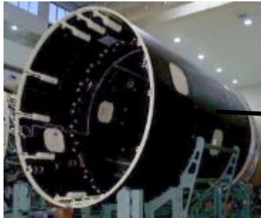
炭素繊維複合材(CFRP) による段間部
