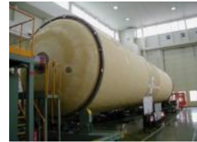
断熱材吹付後のタンク
