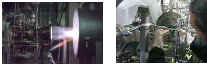
142回の繰り返し着火 点検・寿命評価
