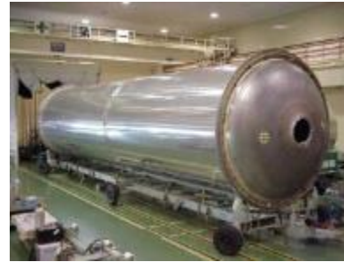
1段LH2タンク(溶接後)
