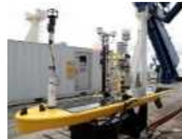
ウェーブライダー：波の力で移動。海面観測と海上気象観測を実施。
