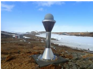
GNSS連続観測点
