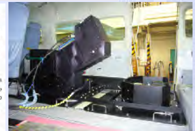
搭載航空機内のART-SEセンサ部
