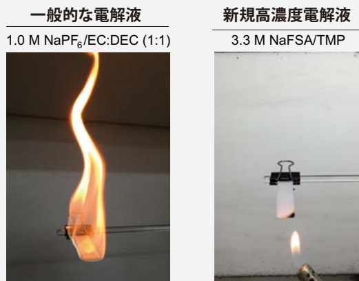
図3 (左) 従来の1.0 M NaPF 6 /EC:DEC (1:1 by vol) 電解液、(右) 研究室で作製した3.3 M NaFSA/TMP電解液の燃焼テスト
