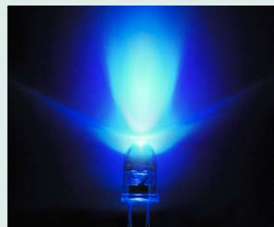
青色LED。車のヘッドライトでは黄色などの 蛍光体に当てて明るい白色光をつくっている。
