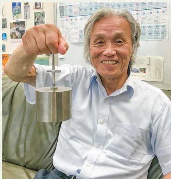
1gのネオジム磁石で3kgの鉄を持ち上げることができる。
