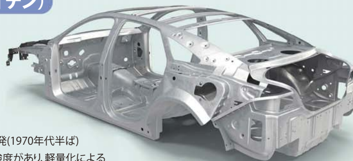
自動車のフレーム
