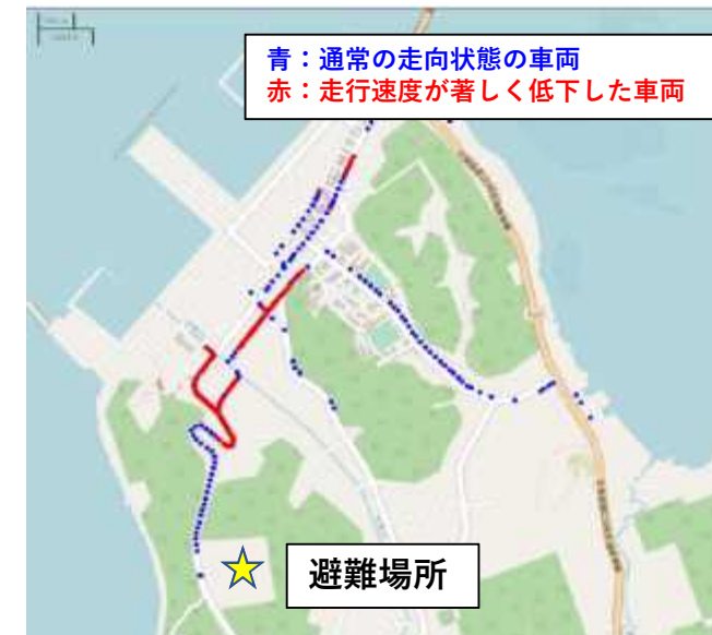
(右)車避難を想定したリスク評価 右上は地形・地質条件に基づいた、発災時における道路の被害箇所の想定。右下は車避難のシミュレーションによって想定された渋滞の発生箇所。
