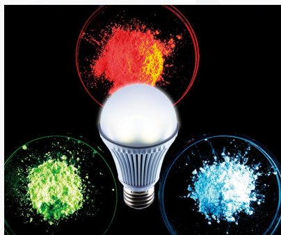
LED照明の普及を加速した サイアロン蛍光体
