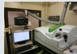
ICP-MSを用いた<sup>90</sup>Sr分析装置
