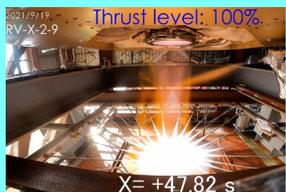
図1 エンジン地上燃焼試験 (エンジン推力100%)
