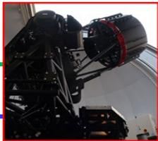
更新後の1m口径光学望遠鏡
