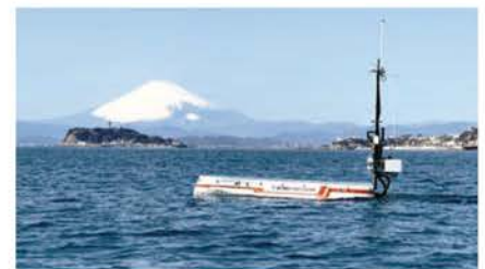
鎌倉沖を自律航行する OC の統合実証機「β機」
