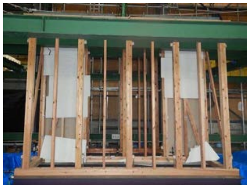
写真 4．筋交いあり試験体における K-NET穴水100%後の損傷状態（拠点間連携共同研究[課題番号：CT0C08]）
