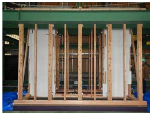
写真 3．筋交いなし試験体における K-NET穴水100%後の損傷状態（拠点間連携共同研究[課題番号：CT0C08]）
