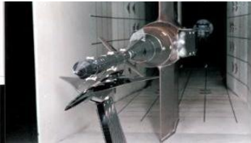
1m×1m超音速風洞
