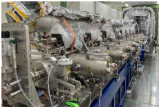
IFMIF/EVEDA開発試験棟で据付調整が進む超伝導高周波加速器
