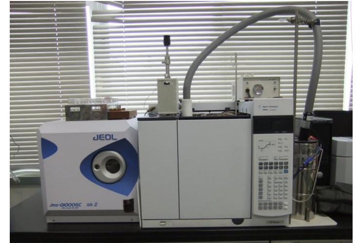
次世代エネルギー素材の開発に不可欠な 温度特性－質量分離同時評価システム
