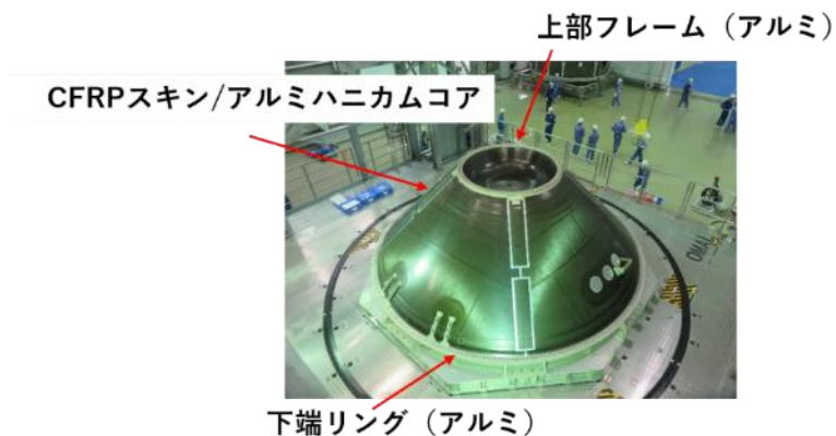
図 1.4.3-1 衛星搭載アダプタ (PSS) 外観
