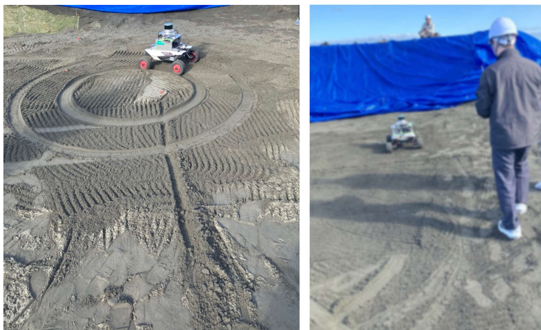
図 2.1-6 福島ロボットテストフィールドでのデータ計測風景(旋回試験)
