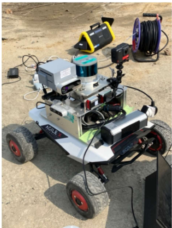
図 2.3-27 会津大学のローバにライブストリーミング実証のための機材を搭載した。
