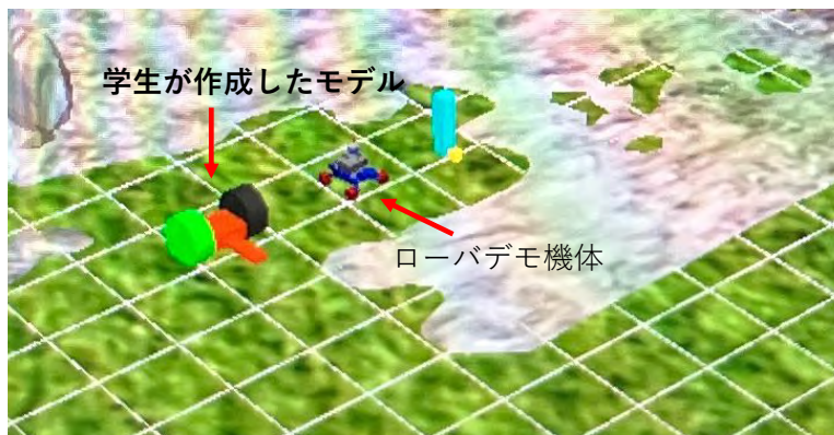
図 2.2-23 ベンチャー体験工房で学部学生が試作した独自ローバモデル(中央の緑と黒の車輪)ローバデモ機体(右隣)に比べて車輪(と本体)を大型化することで、月面走行速度の向上を目指した。
