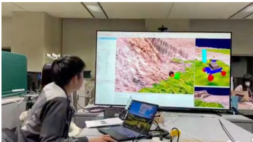
図 2.2-24 ベンチャー体験工房の普段の作業風景 バーチャル箱庭内に作成したローバモデル(画面中央)を走行させ、タイヤのサイズや機体長と走行性能がどのように関係するのかを評価した。
