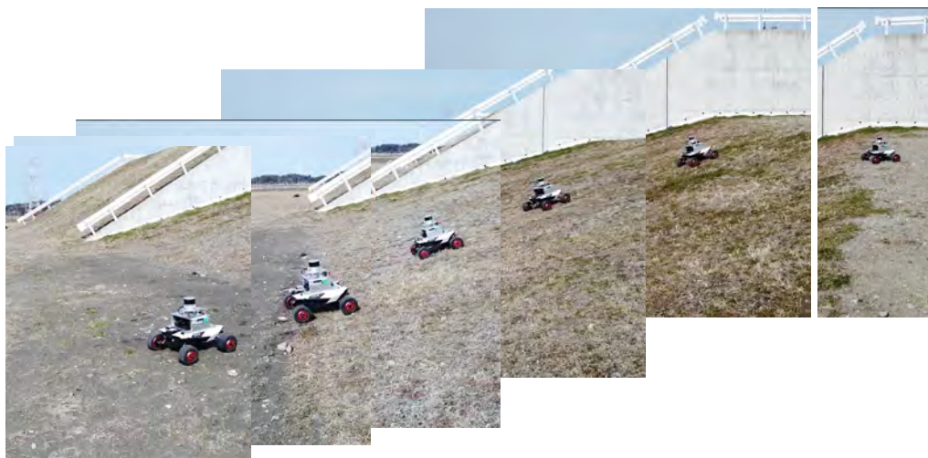
図 2.1-2 ローバデモ機体による緩斜面（15度傾斜部）の走行状況（動画からの切り出し画像）作成したローバデモ機体が要求仕様（リモートコントローラを用いた15度傾斜部の走行が可能）を満たしていることが確認できた。
