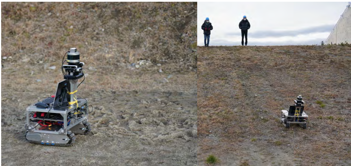
図2 本事業で用いたロボット機体（屋外での試験走行風景） 屋外の不整地での走破性能（左）と傾斜地での走破性能（右）を確認した
