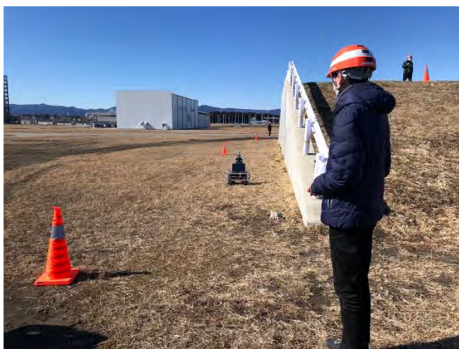
左：不整地上での実際の走行データ取得風景、右：走行路の全景（手前が 15 度、奥が 30 度の傾斜）
