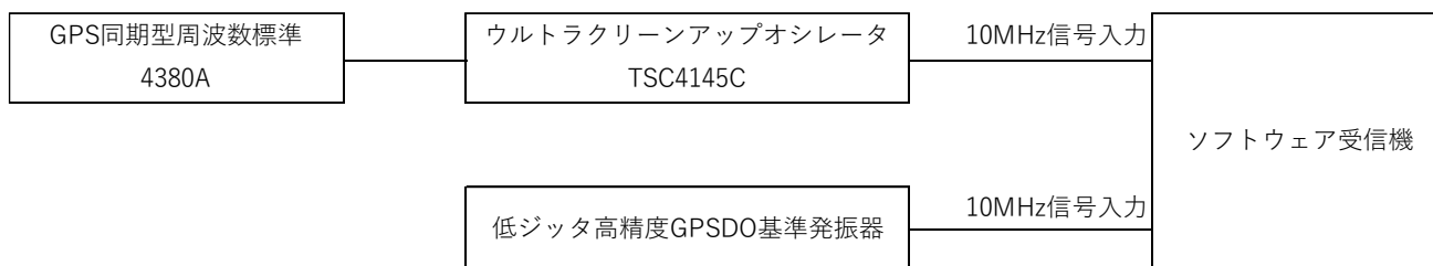
図 3-2-6 ウルトラクリーンアップオシレータの単体試験のブロック図
