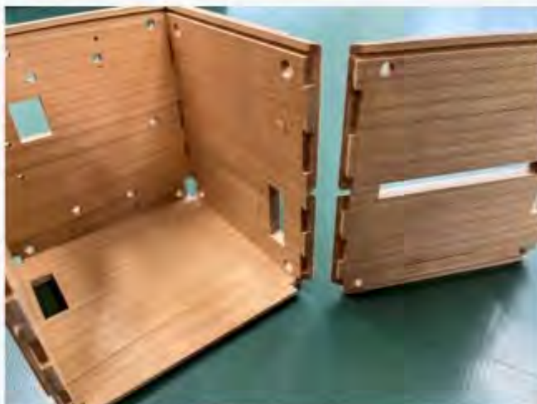
箱形開し機構接ぎで組み上げられる構体（出典：京都大学）
