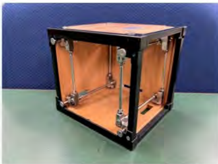
LignoSatの内部。木製のパネルにアルミニウムのフレーム、ステンレス鋼のシャフトで構成されている（出典：京都大学）
