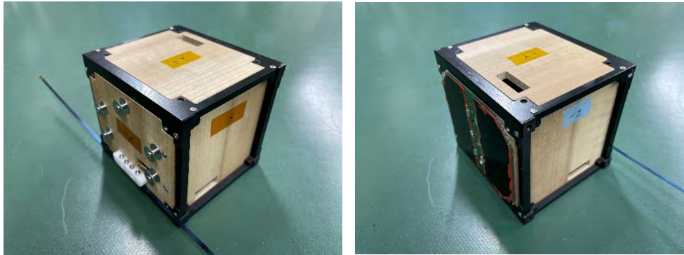
図 1-5 第 7 世代 (Version 7) LignoSat Engineering Model
