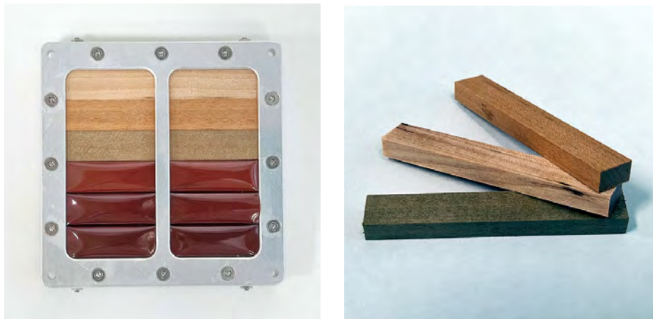
図 2-1 木材曝露試験体 ©京都大学 ©Space BD
