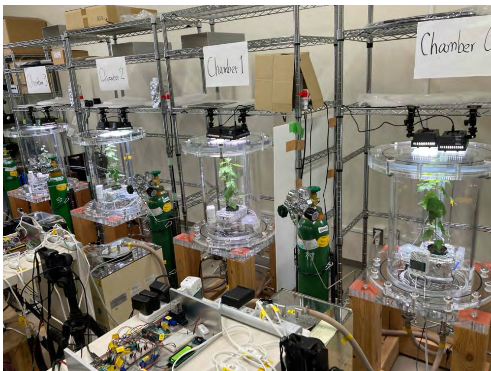
図3-1 低圧下樹木育成実験風景、チャンバー（LPTGEA）内にはポプラ苗木 右から対照区（1気圧）、低圧区（0.75気圧、0.2気圧、0.1気圧）
