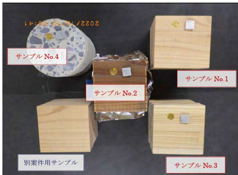
図 2-11 中性子照射試験体：①気乾スギ材（密度 290kg/m 3 ）、②飽水状態のスギ試験体（密度 1090kg/m 3 ）、③ホウ素系不燃木材（密度 670kg/m 3 ）、④コンクリート（密度 2110kg/m 3 ）
