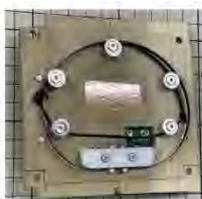
図 1：テグスでアンテナを結んだ状態。 ISS 放出後、右下にあるバナナ状のクロム線 を加熱しテグスを焼き切る。
