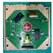
図 4 LignoSat のひずみゲージ貼り付け面 アンテナ基板が取り付けられている。
