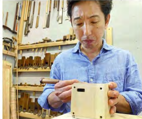
伝統工法を駆使して木造人工衛星を製作する白井さん（黒田工房提供）
