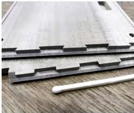
くぎや接着剤を使わず固定するために彫り込まれた「留形隠し継ぎ」の凹凸（黒田工房提供）
