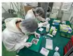
図 2 FM 太陽光パネル接合作業
