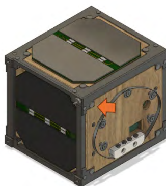
図 1-14 加速度測定点
