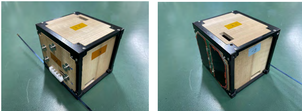
図 1-5 第 7 世代 (Version 7) LignoSat Engineering Model
