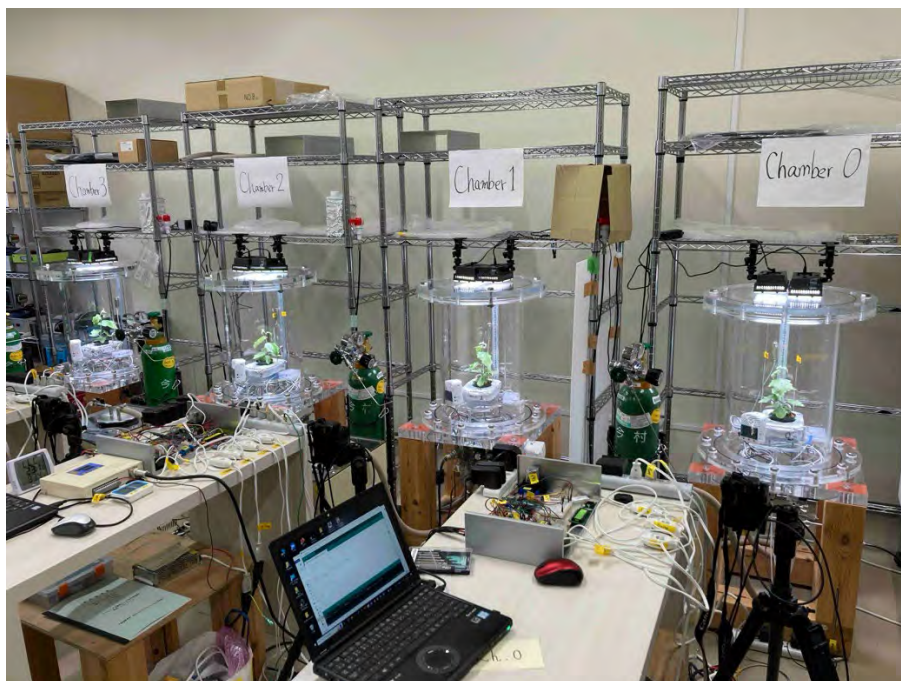
図3-3 低圧下樹木育成実験風景、チャンバー（LPTGEA）内にはポプラ苗木 右から対照区（1気圧）、低圧区（0.75気圧、0.5気圧、0.3気圧）
