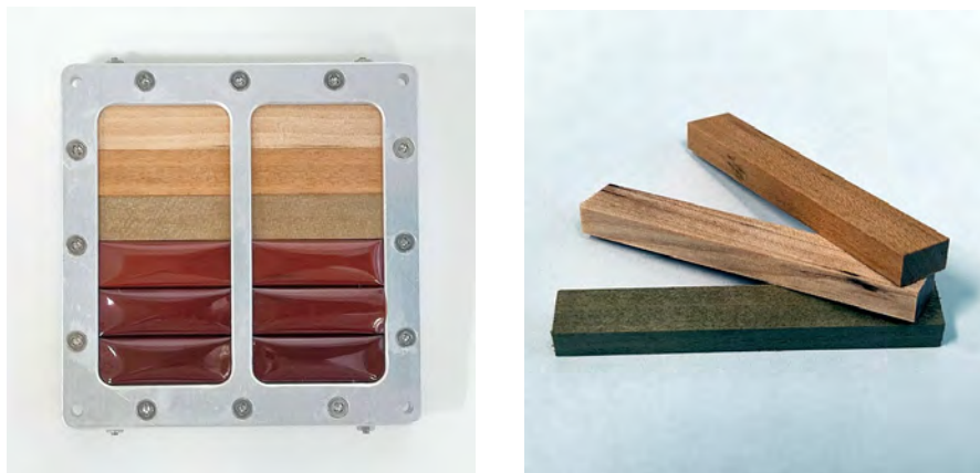
図 2-1 木材曝露試験体 ©京都大学 ©Space BD
