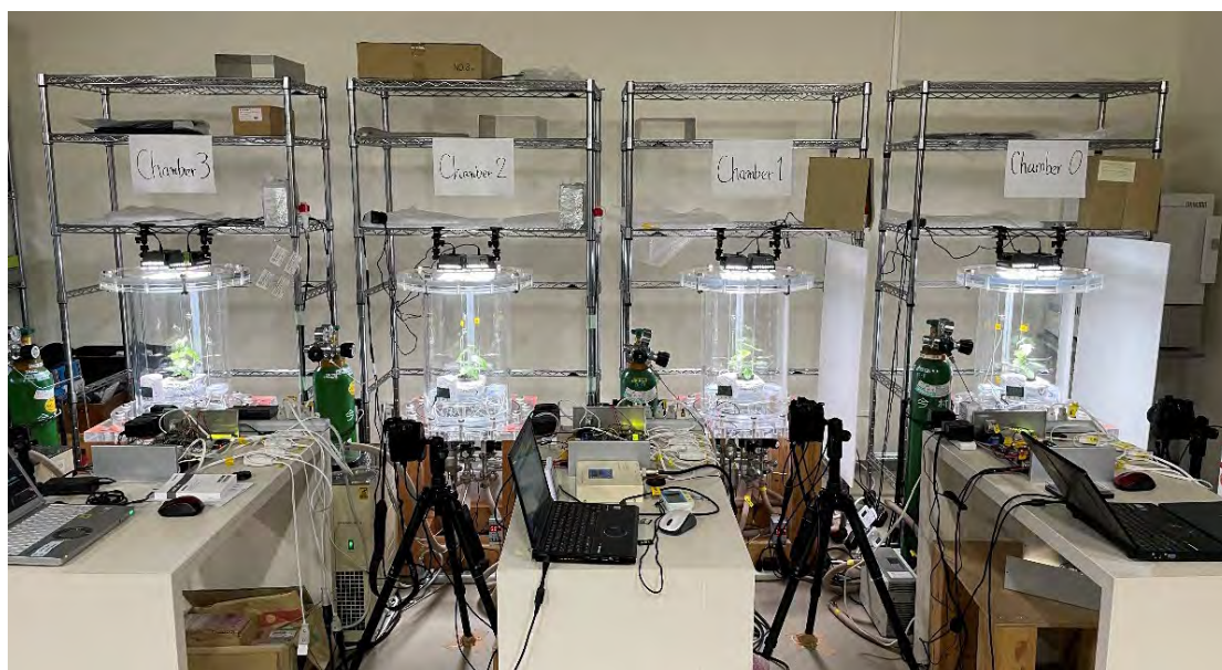
図 3-2 4 基の低圧下樹木育成実験装置
