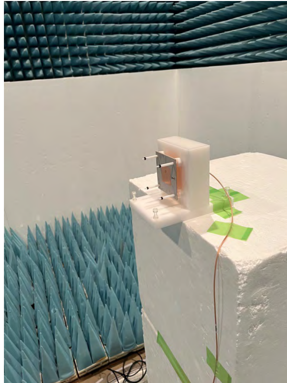
図 1-20 S11 値計測時の様子
