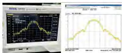
図 1 実測波形 (左図) と理論波形 (右図)
