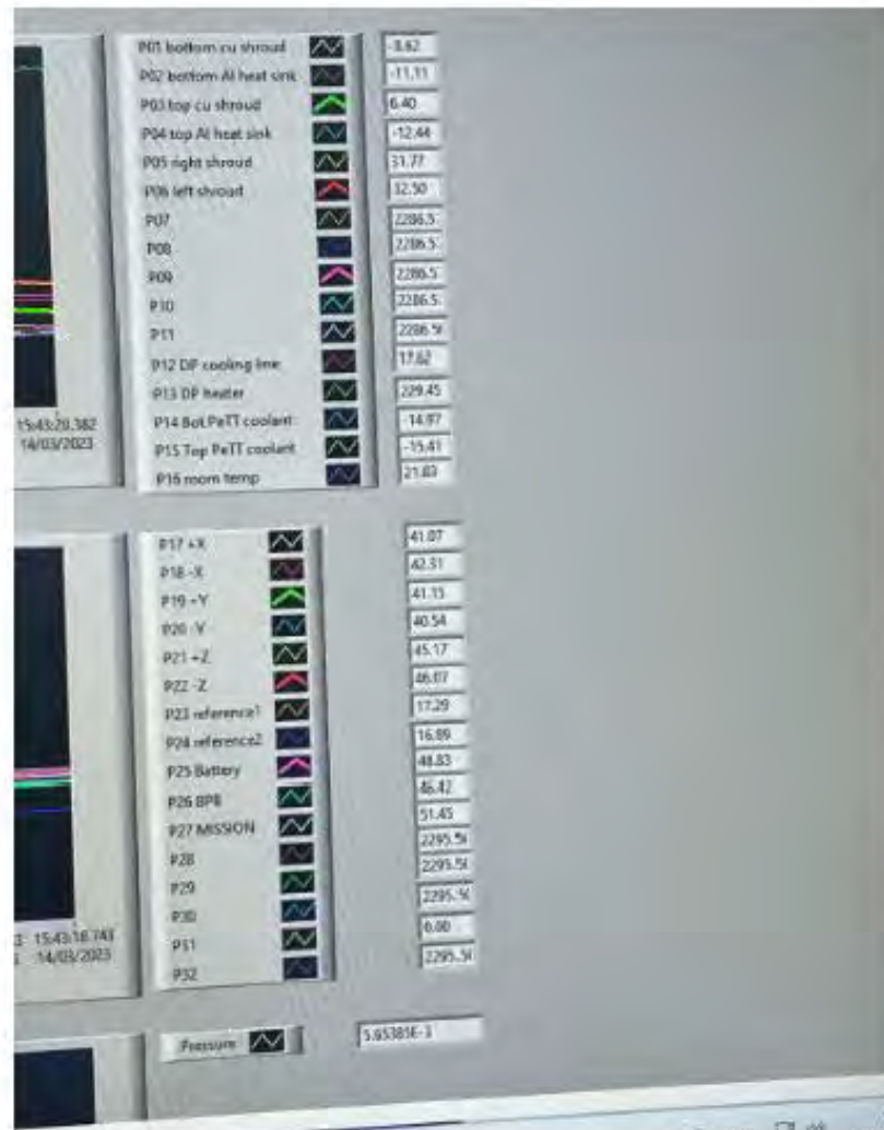
図7 出力される熱電対データ (60℃時)
