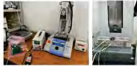
曲げフォースゲージによるひずみ測定
