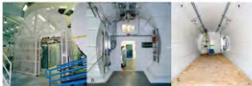
Bioregenerative Life Support Systems Test Complex (BIO-Plex) 10) NASA ジョンソン宇宙センターに建設の4人が1年間滞在できる大型有人設備として建設された。 A) View of exterior B) View of interior C) View of interior
