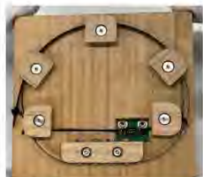
図 5 UHF 帯用アンテナ展開機構
