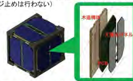
cf.) RTV-S 691による太陽光パネル接着
