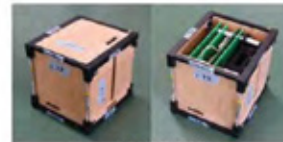
LignoSat 構造試験用モデル(STM)
