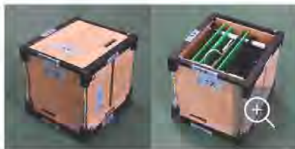
開発中の木造人工衛星「リグノサット」＝京都大提供
