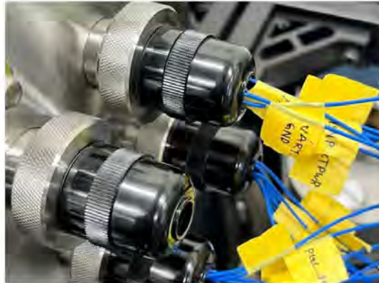
図 2 空気漏れが確認できたコネクタ
