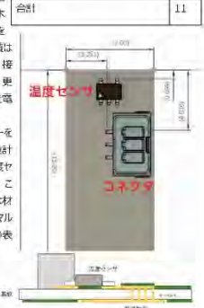
図 5 温度センサー基板。(上) 表面、(下) 断面
