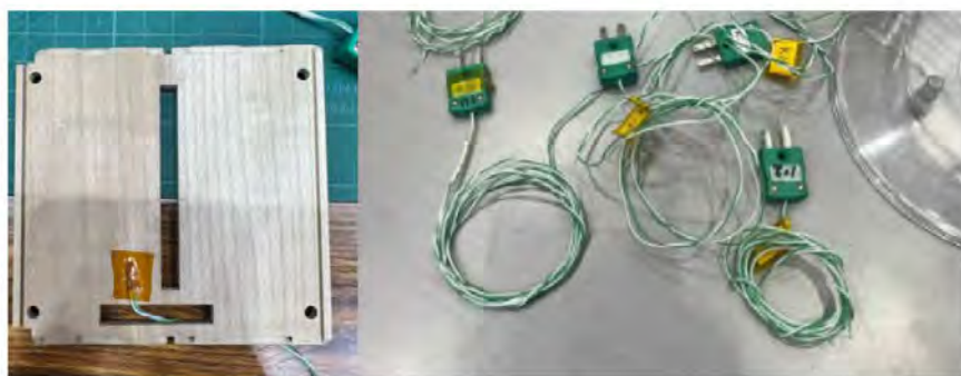
図 6 木造パネルに張り付けられた様子（左）と熱電対（右）
