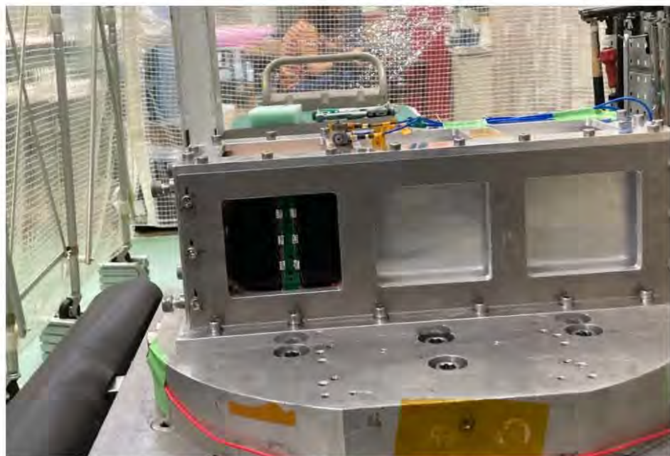
図 1 ヤマザクラ構体振動試験の様子
