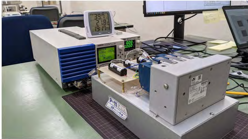
図3-2 セルスクリーニングの特性試験装置
