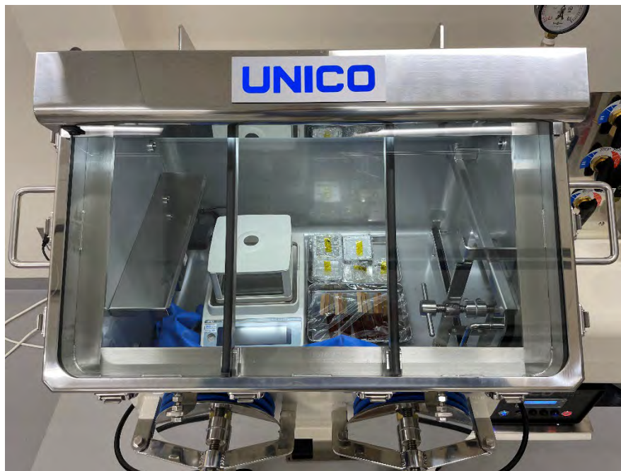
図 2-6 京都大学グローブボックス内に保管されている木材宇宙曝露試験体
