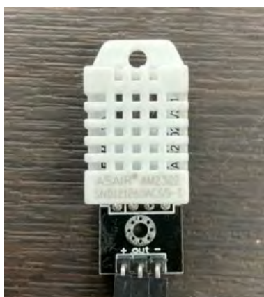
図 3-3 温湿度センサー DHT-22 (AOSONG 社)
