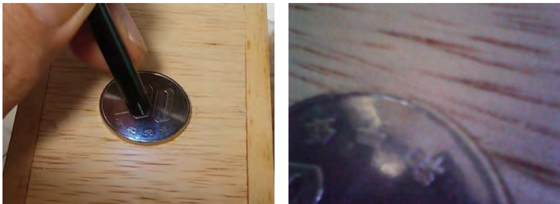
図6 小型カメラによる木材表面の撮影(左)と撮影された画像の例(右)
