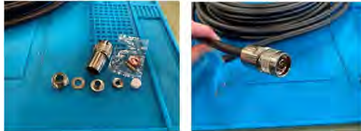
図：同軸コネクタ（左：作成前、右：作成後）
