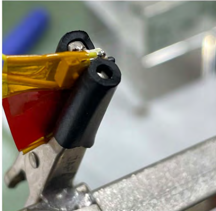
図6-1 デプロイメントスイッチのはんだ付け作業
