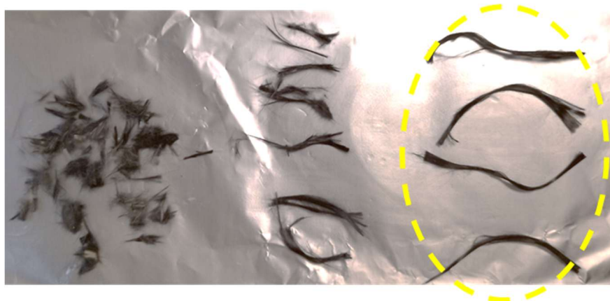
図 4 CFRP より DBU 分解処理にて採取した炭素繊維束
