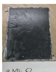
図 29 GL 添加ウレタン系樹脂 CFRP の試作外観(サイズ:A4) (左図:改質リグニン 0%添加 CFRP、右図:改質リグニン 12.5%添加 CFRP)
