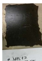
図 29 GL 添加ウレタン系樹脂 CFRP の試作外観(サイズ:A4) (左図:改質リグニン 0%添加 CFRP、右図:改質リグニン 12.5%添加 CFRP)
