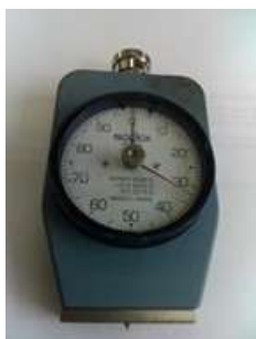
図21 硬度計(ショア-硬度D)
